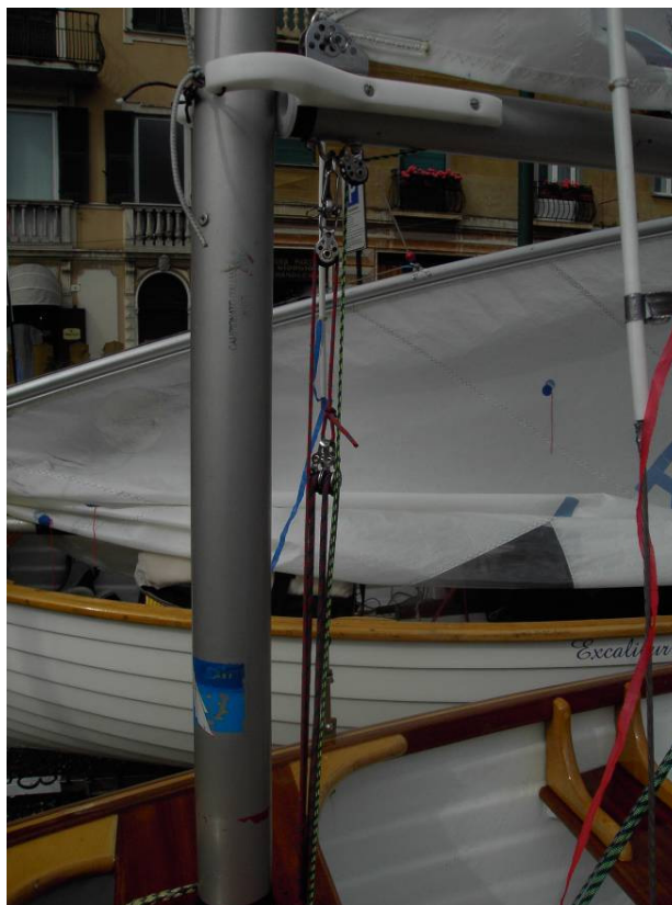
Caricabasso molto demoltiplicato e base rinvata in coperta
