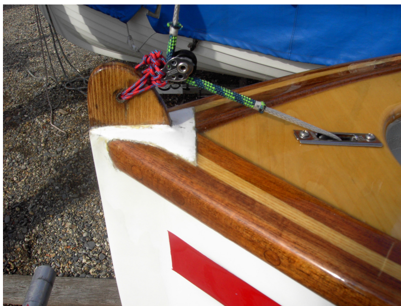
Esempio di bozzello sulla pernaccia: andrebbe avvicinato ad essa
