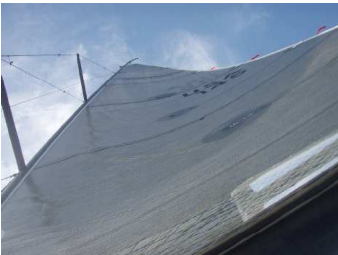
Regolazione randa con 16-17 nodi. Carrello appena sopra il centro, moderata tensione di scotta, paterazzo a 8-10 sulla scala numerata.
