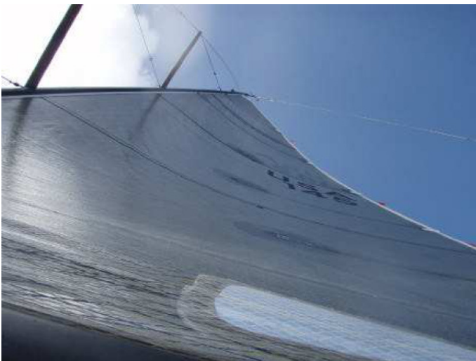
Regolazione randa con 13-14 nodi. Carrello appena sotto il centro, moderata tensione di scotta, paterazzo a 6-8 sulla scala numerata.
